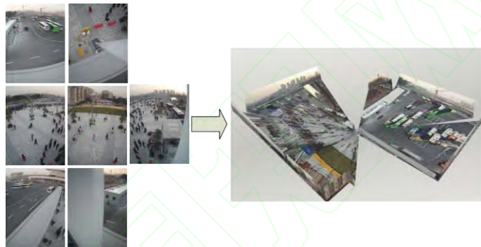
图4 某火车站6幅相机图片的链式建模结果
